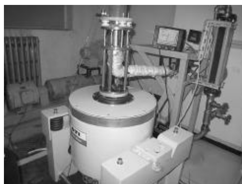
图6 催化器热振动试验系统
