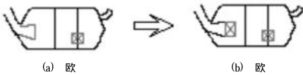
图2 应对欧 I、欧 II 法规,摩托车催化器的安装
