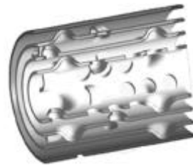
图 4 多个热管层叠套在一起的催化器结构
